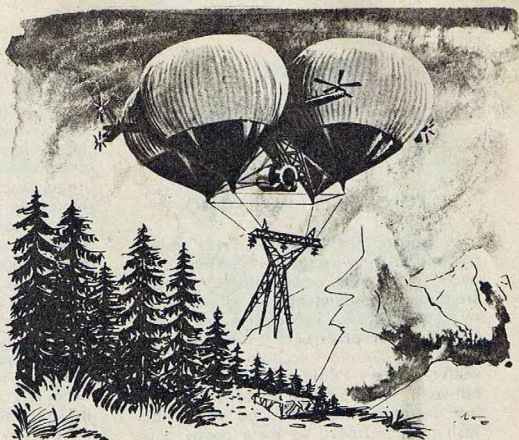
„Obelix” — francuski projekt sterowca cztero-balonowego. Prędkość 80 km/h, nośność 500 ton
